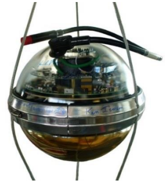
Рис. 3. Оптичний модуль детектора нейтрино AMANDA в північній півкулі
