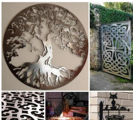
Рис. 10. Вироби, виготовлені за допомогою плазмової різки металу.
