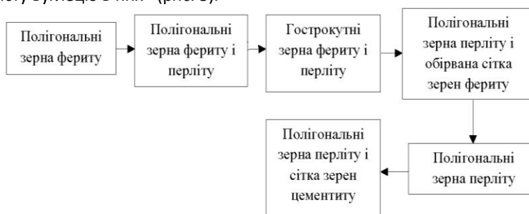
Рис. 4. Структурно-логічна схема «Перетворення форми зерен залізобуглецевих сплавів залежно від вмісту вуглецю»
