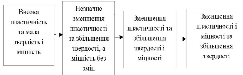
Рис. 5. Структурно-логічна схема «Характер зміни механічних властивостей залізвуглецевих сплавів залежно від вмісту вуглецю»
