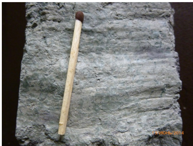
Скол керна алевролита по оси скважины 9Д, глубина 77 м.
